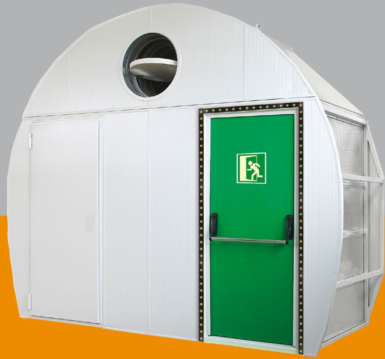
[Imagen superior] MODULBYP Vista 1. Vista exterior de la pared de MODULBYP del lado del túnel, construida con panel aislante que garantiza una resistencia al fuego de clase RF120. Consta de dos puertas peatonales y un ventilador axial con válvula cortafuegos.
